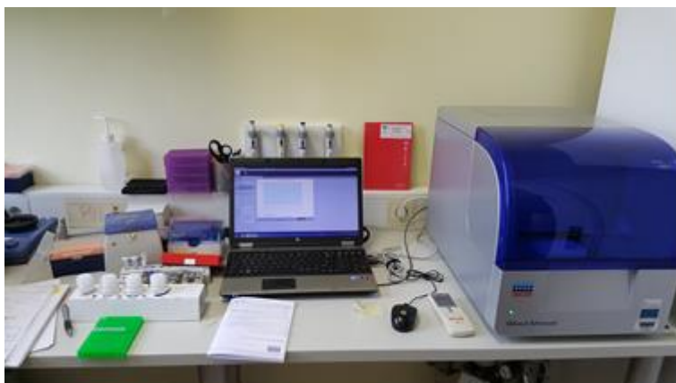
Slika 2: Fragmentna analiza PCR produktov na QX HR kapilarni elektroforezi
